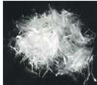
*“Fiber-Melk N reduce significativamente las grietas por contracción e incrementa las resistencias mecánicas.”*
